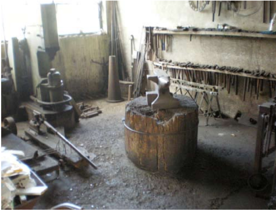
Links hinten ein Schmiedehammer und vorne der Amboss. Rechts an der Wand noch das Schmiedewerkzeug. Foto: Dr. Hans Perlinger 2008.
